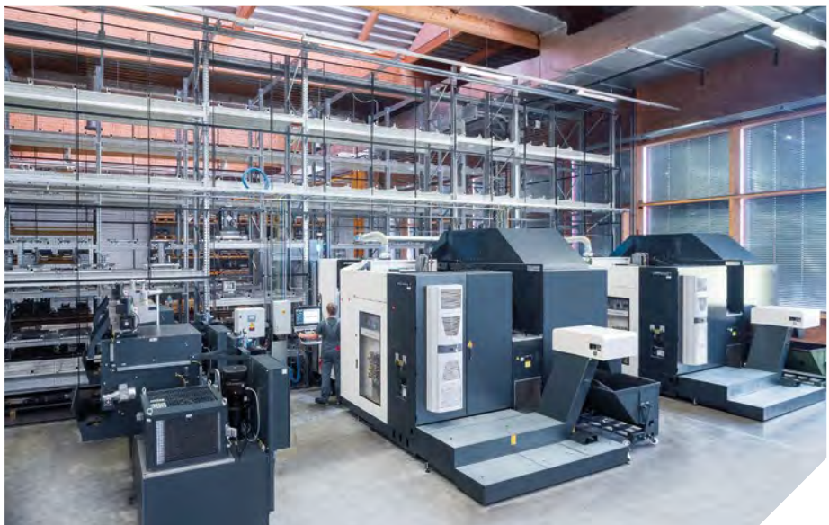
Dvě centra DMC 60 H linear jsou napojena na 100místný zásobník na palety. Ve spojení s 303místným zásobníkem nástrojů je zajištěna autonomní výroba přes noc a o víkendech.
