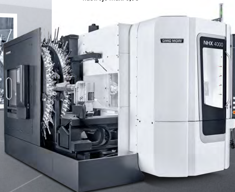
Vnější kotouč s 63 místy na nástroje, vnitřní kotouče s 60 místy.
