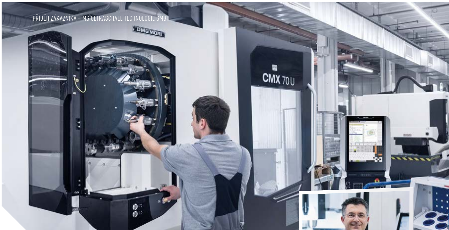
Zakládání souběžně s hlavním časem díky samostatně přístupnému zásobníku nástrojů na soustruhu CMX 70 U.
