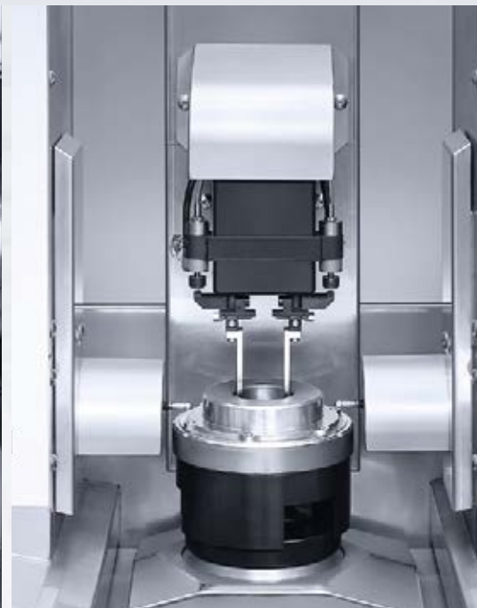
Měřicí stanice pro měření během procesu souběžně s hlavním čásem.
