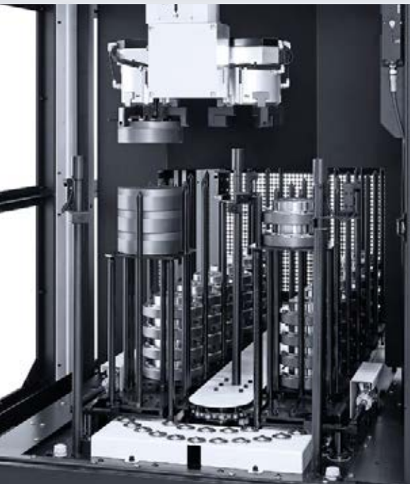
Stohovací zásobník s až 20 místy pro palety po max. 75 kg a až 26 místy pro zatížení 35 kg.
