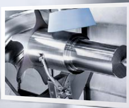
Měření během procesu broušení: opakovaná přesnost měření 5 μm.
