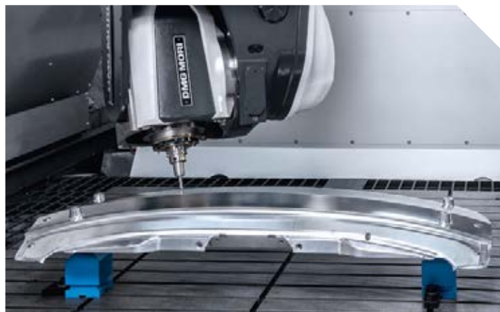
Die & Mold: 5osé simultánní obrábění vložky formy z hliníku.
