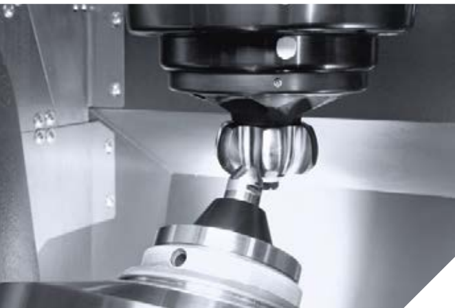
5osé frézování kulového náboje na soustruhu CTV 250 DF.
