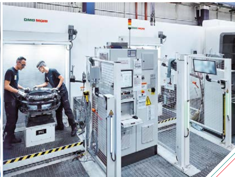
Přípravné pracoviště výrobní linky se čtyřmi stroji DMU 80 FD duoBLOCK.
