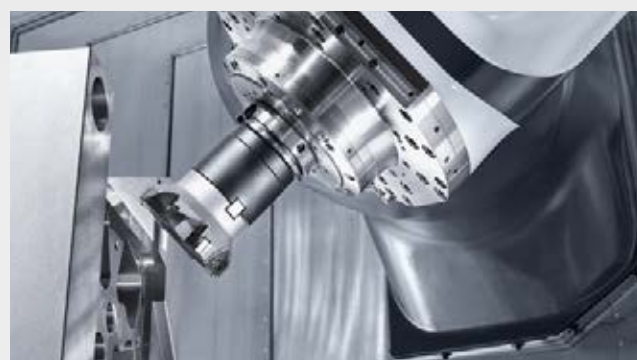
Vřeteno speedMASTER s 20.000 ot/min a 130 Nm | 35 kW (40 % zatíž.).
