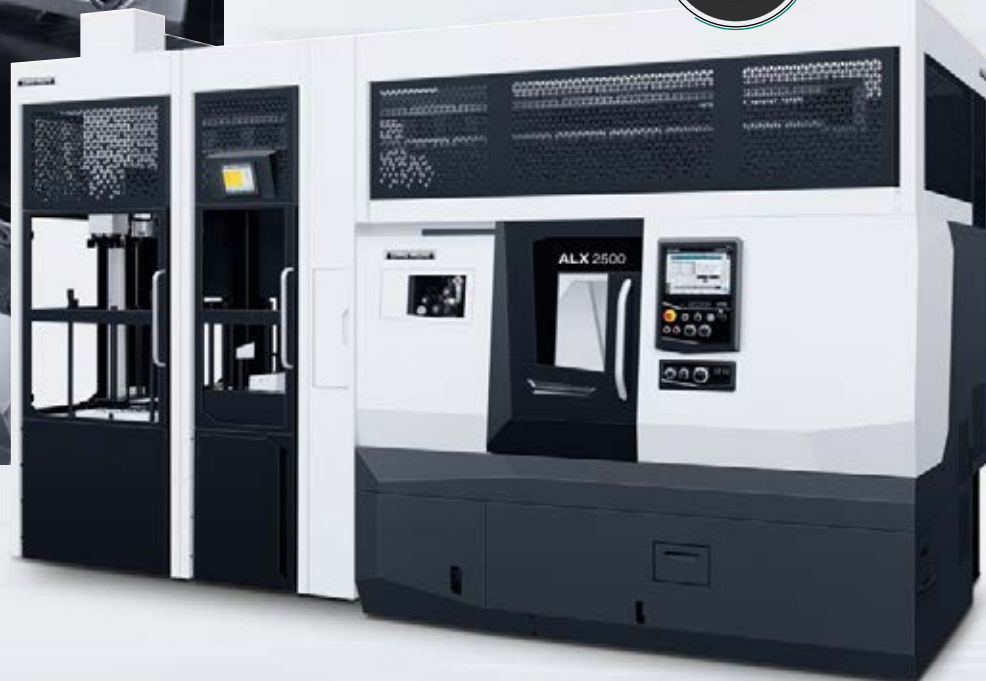
ALX 2500 s gantry zakladačem GX15 pro obrobky do \varnothing 200 \times 150 mm
