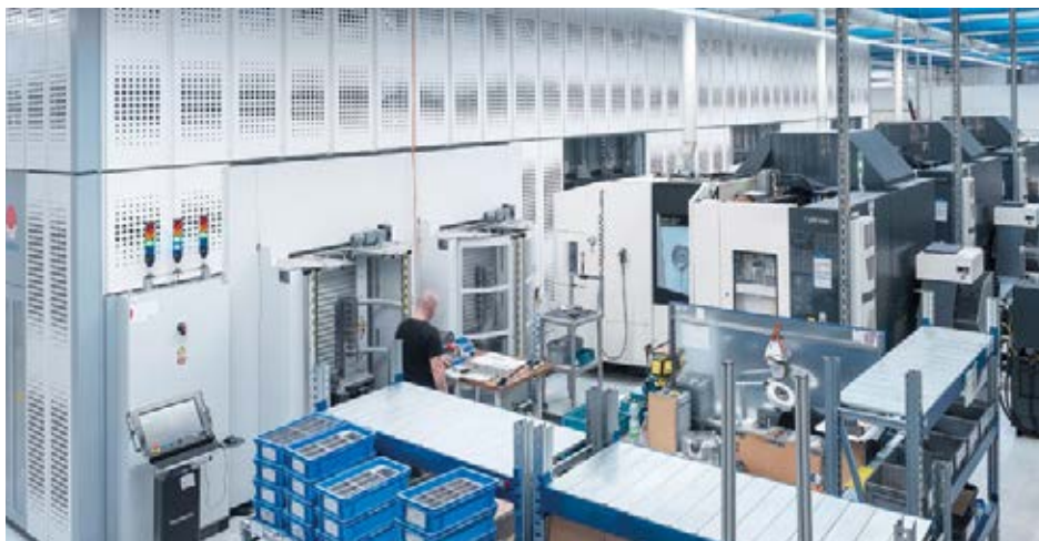
Největší ze zatím instalovaných automatizovaných systémů zahrnuje tři centra DMC 60 H, každé vybavené pětikotoučovým zásobníkem na 303 nástrojů.
