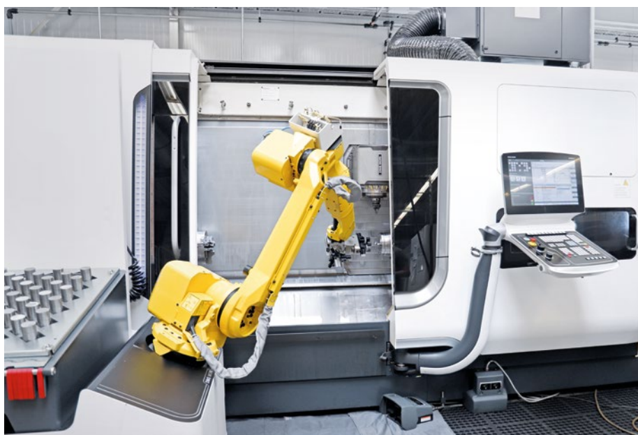
Robo2Go odebrává hotový díl z protivřeten.
