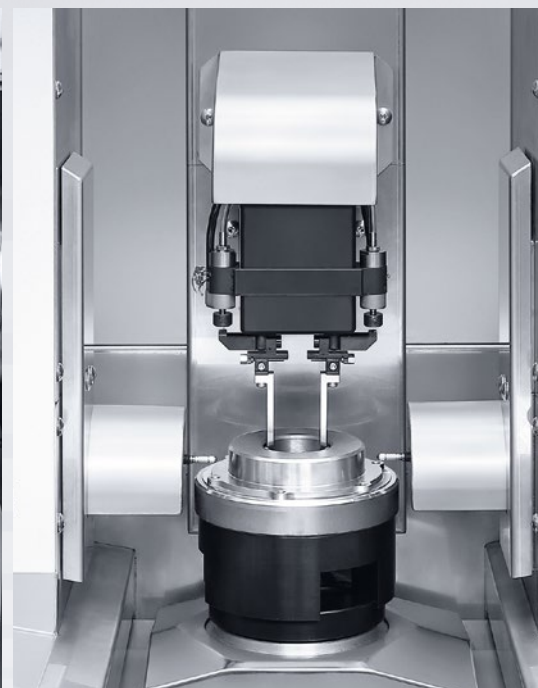
Měřicí stanice pro měření během procesu souběžně s hlavním časem.
