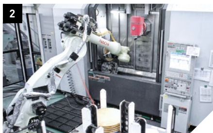
1. Příklad obrobku s hmotností mezi 40 a 50 kg v surovém stavu 2. Automatické robotizované zakládání do stroje NT 4300 DCG
