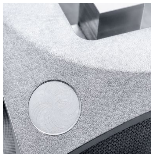
Ve srovnání s běžnými postupy je laserové texturování v mnoha případech podstatně výhodnější, protože odpadá technologické kroky jako erodování nebo leptání.
