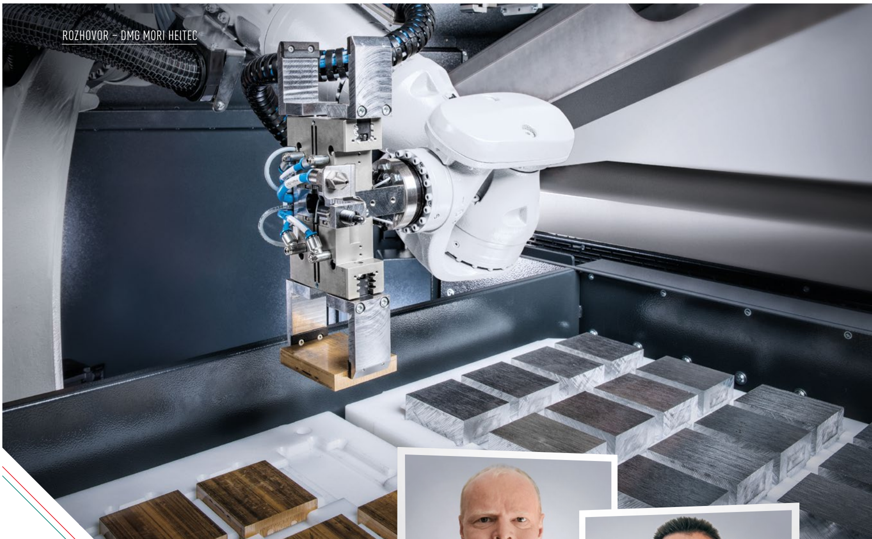
WH 15 CELL: modulární automatizační systém pro obrobky do hmotnosti 15 kg
