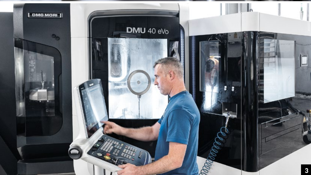
1. Výrobní buňka DMG MORI individuálně koncipovaná jako projekt „na klíč“ pro obrábění lopatek turbin 2. Přesné obrábění v rozsahu několika málo setin milimetru v třísměnném provozu 3. Perfektní přístupnost i pro manuální zakládání
