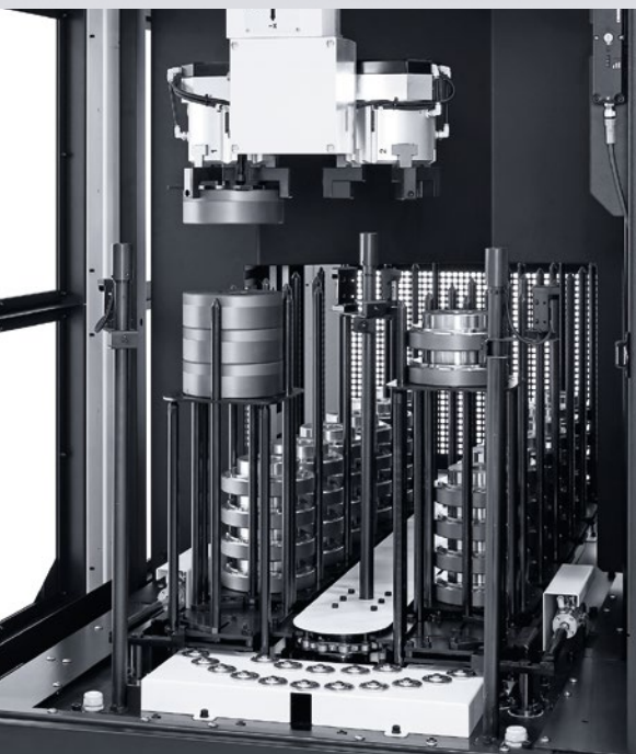
Stohovací zásobník s 10 paletovými místy po 75 kg.
