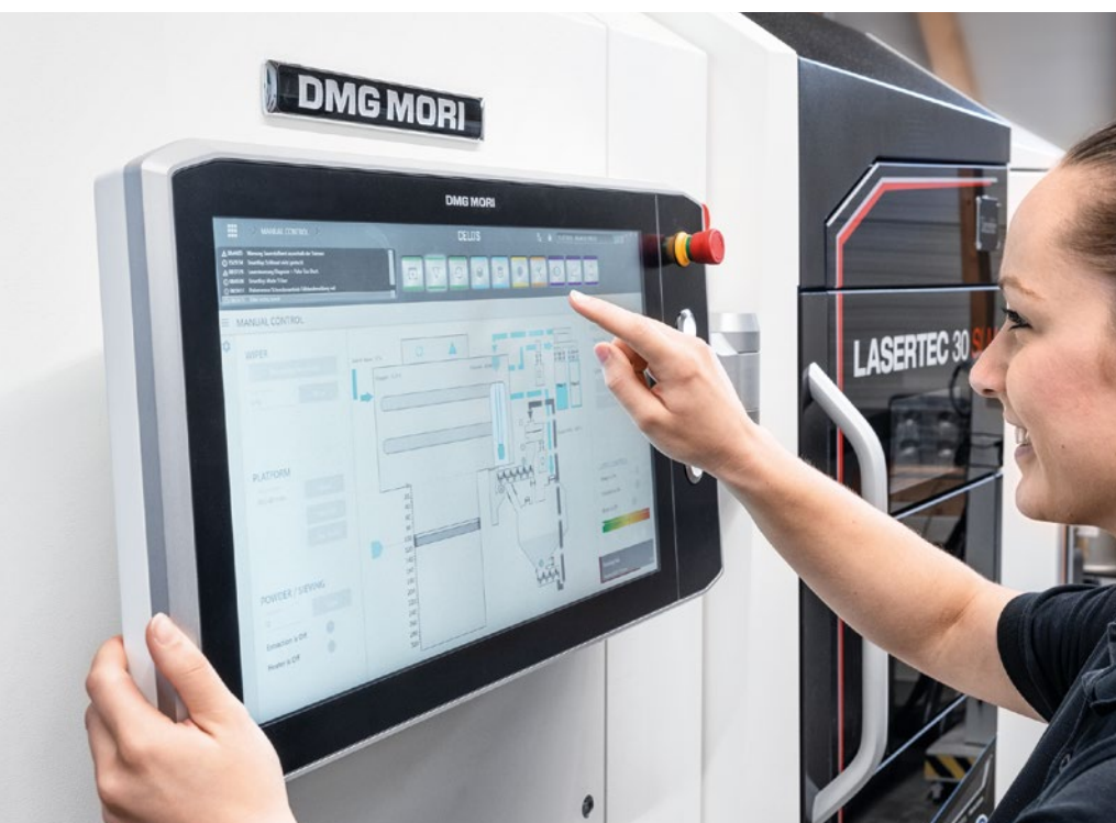
LASERTEC 30 SLM 2. generace je vybavený jednotným řídicím a ovládacím prostředím CELOS.
