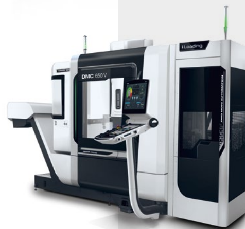
iLoading na DMC 650 V: Hmotnost obrobku max. 5 kg; rozměry obrobku max. 80×80×80 mm, realizovatelný cyklus 8 sekund na jeden díl
