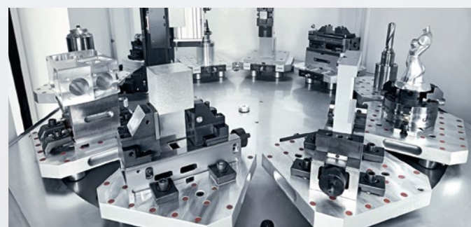
PH 150 – 8 místný zásobník palet; nosnost 250 kg vč. palety (volitelně 350 kg)
