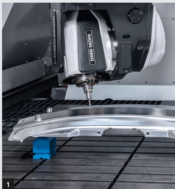
1. Frézovací hlava 45° nebo 90° pro 5osé obrábění s až 30.000 ot/min
