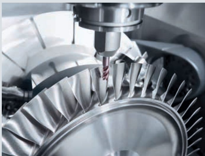
Nejvyšší stabilita a dynamika řady monoBLOCK® tvoří ideální podmínky pro obrábění lopatkových kol.
