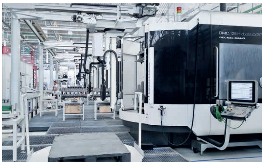
Pro společnost FPT Industrial Argentina S.A. navrhla společnost DMG MORI Systems výrobní linku s celkem 13 obráběcími centry DMC jako projekt na klíč.
