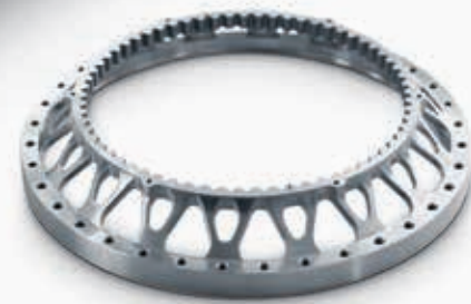
Kotouč brzdových destiček Soustružení na CTX beta 800 Frézování na DMU 80 eVo linear Materiál: titan Čas obrábění: 5osé frézování cca. 7 hod
