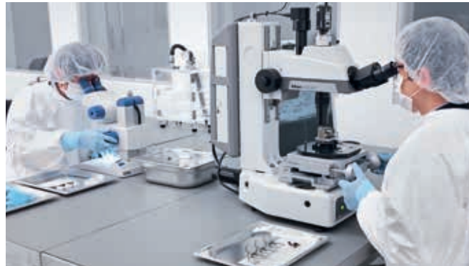
Nyní v závodech Wernau: seřizování senzorů pomocí mikroskopu s přesností 2 µm.
