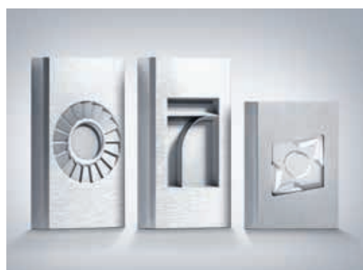
Laserové obrábění zahloubených 3D kontur v tvrdokovu pomocí pikosekundového laseru.
