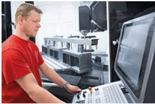
5osé simultánní obrábění velkých dílů na stroji DMU 340 P.
