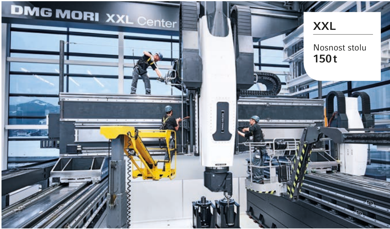
Nahoře: DMU 600 G linear ve středisku XXL Center společnosti DECKEL MAHO Pfronten, nejmodernější výrobě velkých strojů na světě. Dole: Stálá vysoká přesnost díky termické stabilitě konstrukce stroje.
