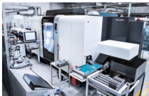
Výroba na automatu SPRINT 65 s maximální přesností, např. rovinností 0,004 mm.
