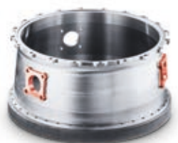
Spojování více materiálů, např. mědi na inconelu
