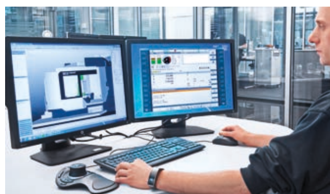
DMG MORI Virtual Machine je obrazem 1:1 frézovacího centra DMC 160 H duoBLOCK® včetně skutečného řídicího systému.
