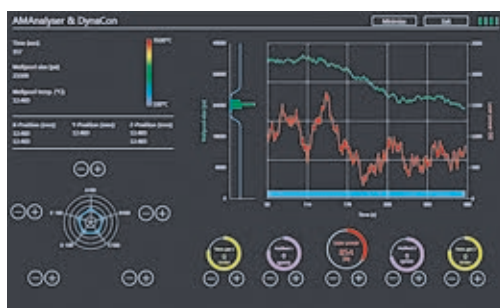
Adaptivní kontrola procesu Automatická úprava výkonu laseru.
