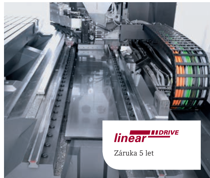
Lineární pohon osy X s rychloposuvem až 80 m/min.
