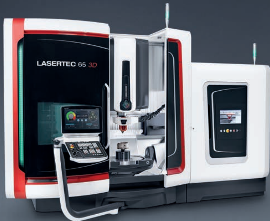
Flexibilní rozhraní HSK: LASER + frézování + ULTRASONIC*
