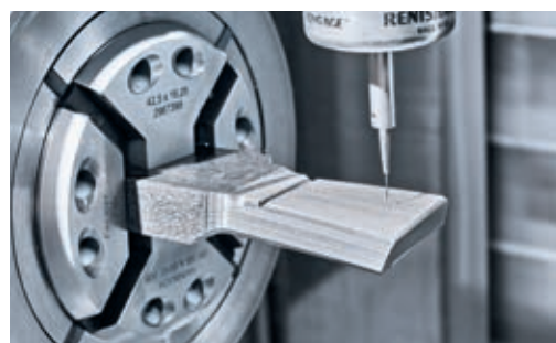
5osé simultánní obrábění nožů pro válcové nožové frézy na stroji NTX 1000.
