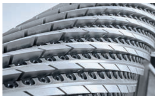
Válcová fréza osazená několika sty noži.
