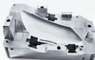
Vstřikovací forma na reflektor Stroj: HSC 70 linear Materiál: 1.2312 Rozměry: 680 × 400 × 350 mm, Ra < 0,15 μm
