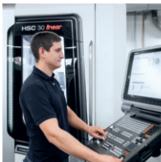
HSC 30 linear – vřeteno s 40.000 ot/min a lineární pohony zajišťují obrábění s přesností v rozsahu mikrometrů, a to i u těžce obrobitelných materiálů, např. wolframu nebo mědi.
